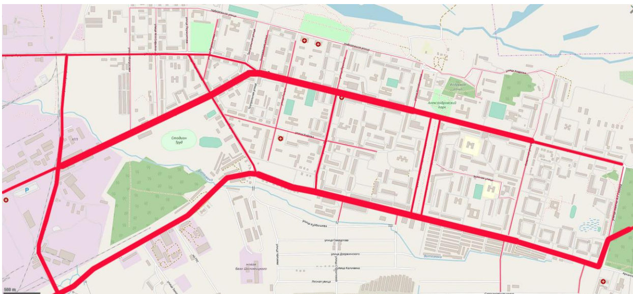
Рисунок 4.2. Картограмма расчетной интенсивности движения легковых автомобильного транспорта в пиковый период на 2035 год.
